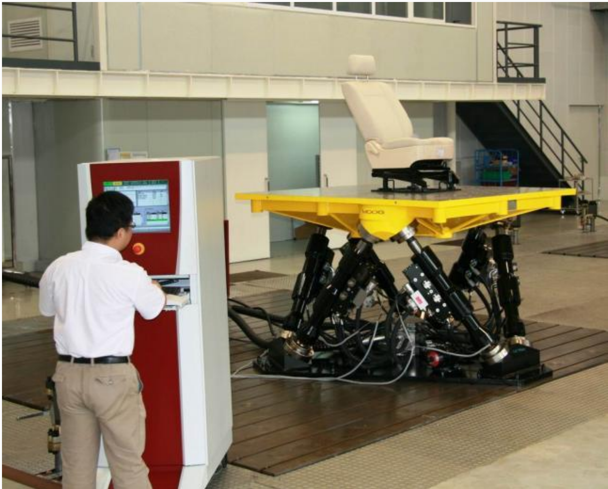
Ova elektronička stolica podvrgava se ispitivanju tresilicom.
