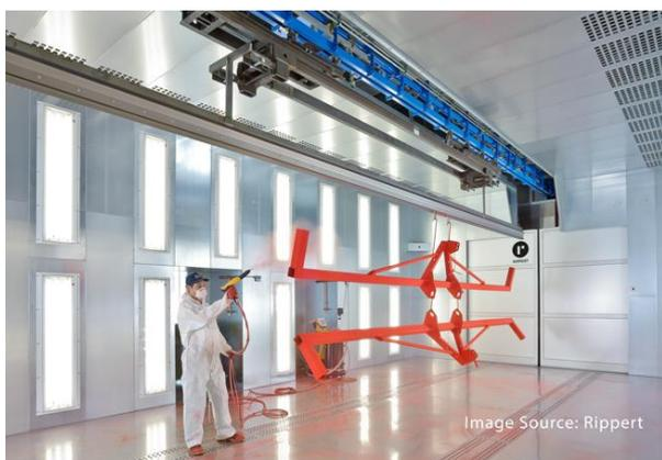
Norma EN 16985 zamjenjuje tri postojeće norme o komorama za nanošenje prevlaka prskanjem, EN 12215, EN 12981 i EN 13355, objedinjujući ih u jednu sigurnosnu normu. Prednosti nove norme obuhvaćaju razne dimenzije: ne samo da pojednostavnjuje provedbu povezanih mjera nego i nastoji ostvariti troškovnu/energetsku učinkovitost (uz ograničenje sigurnosnih zahtjeva) i smanjenje utjecaja na okoliš.
