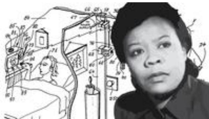
se vidi kroz rupice. Ono što kamera snimi prenosilo se na ekran u stanu, a s posjetiteljem se moglo razgovarati putem dvosmjernog mikrofona. Osim toga, pomoću tipke se mogao pokrenuti alarm ili daljinski otključati vrata.
