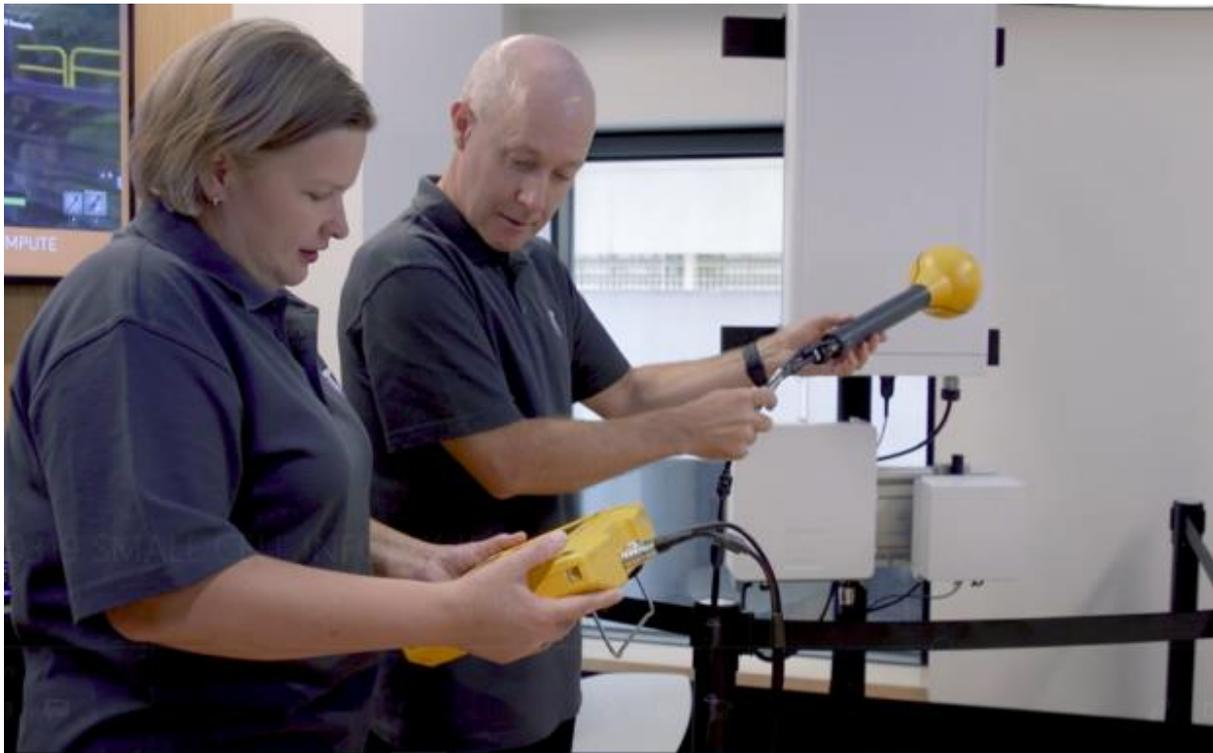
*Ispitivanje elektromagnetske energije 5G antene (foto: Telstra Labs)*
