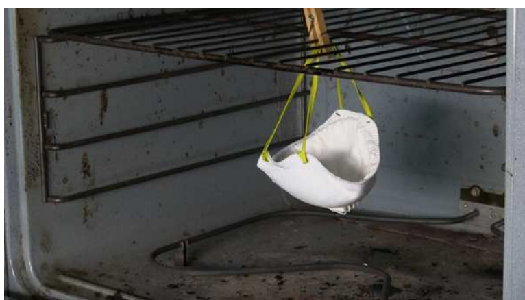
Dezinfekcija respiratora u peći
